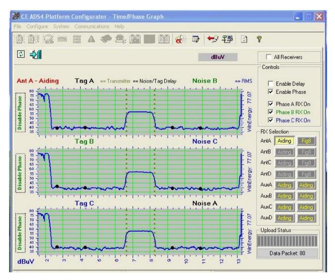
Во вкладке **RX Selection** выбираем антенну, и способ поляризации, для которого мы хотим увидеть график, далее нажимаем **Request Unfiltered Time/Phase Graph**(значок обновить).
