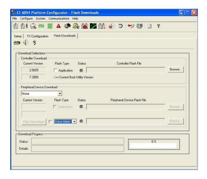
В разделе Controller download можно «прошить» контроллер (последняя версия прошивки поставляется с конфигуратором)
