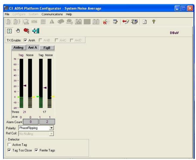
Здесь мы видим уровень шума в поляризациях Aiding и Figure8 и количество сработок для каждого из способов поляризации.
