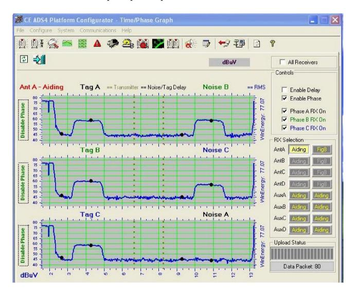
Все акусто-магнитные противокражные системы должны быть синхнонизированы по фазе!
