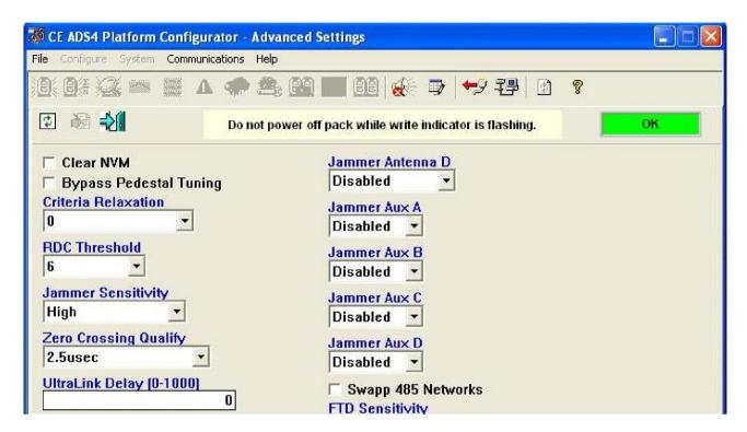
Здесь можно сбросить контроллер на заводские установки. Для этого нужно поставить галочку **Clear NVM** и нажать кнопку **обновить.**
