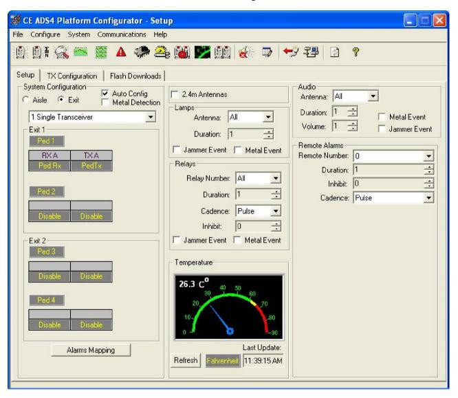
Ставим галочку «**Auto Config**» и удостоверимся, что конфигуратор правильно определил конфигурацию нашей системы (в данном случае подключен один педистал Ultra Exit), если конфигурация не определилась, то выбираем вручную.
