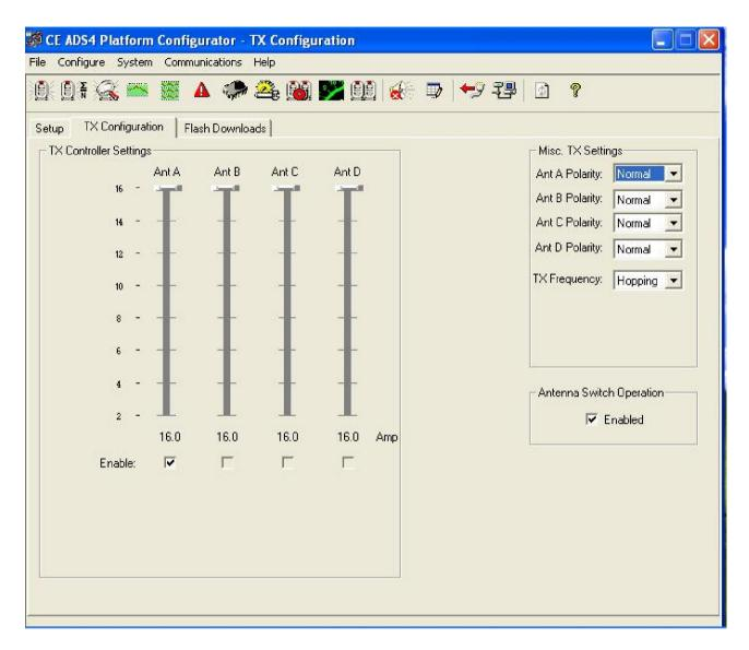
В разделе **TX** Controller Settings мы можем понизить мощность передатчика либо полностью отключить его передвигая ползунок нужной нам антенны (отключение передатчика помогает при вывлении причины ложных сработок системы, если при выключении всех передатчиков ложные сработи прекращаются, то в зоне детекции системы находится антикражные бирки, о которых клиент может не знать)
