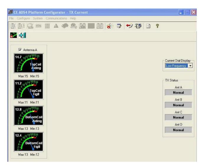
Здесь мы смотрим уровень токов в верхней и нижней петле контура антенны. Уровень должен быть примерно одинаковым во всех антеннах, подключенных к контроллеру, если показатели токов в антеннах сильно отличаются, то они будут плохо работать в паре (например система dual), требуется произвести настройку резонанса антенн (см. инструкцию по настройке резонанса).
